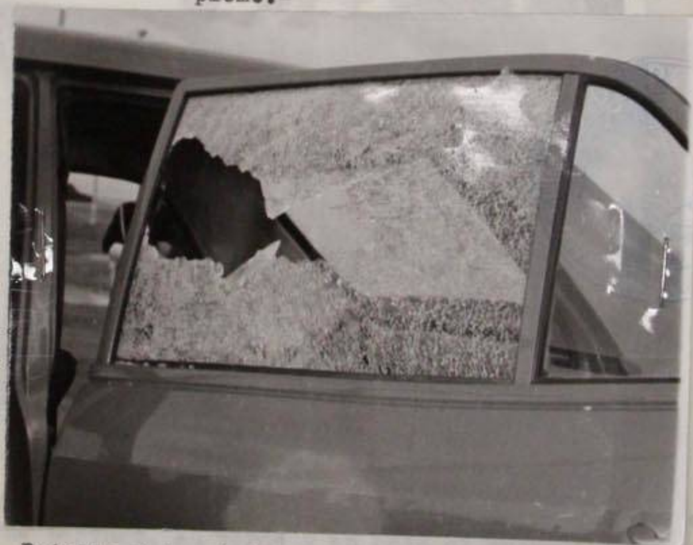
Detalle del cristal de la puerta trasera izquierda del auto Matr. 3057 mostrando el daño sufrido por un impacto de proyectil de arma de fuego.-
